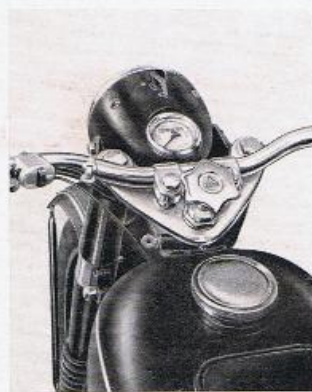
Teleskopgabel progressiv federnd, mit Oldämpfung und Steuerungsämpfer. Lenkungsloch neuester Konstruktion.
