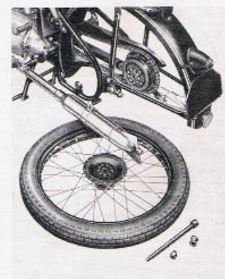
Hinterrad-Steckachse ermöglicht bequeme Herausnahme des Rades ohne Abnehmen der Kette und ohne Veränderung der Kettenspannung.
